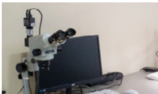
Тринокулярные микроскопы серии EMZ. Через видеосистему изображение выводится на экран компьютера.
